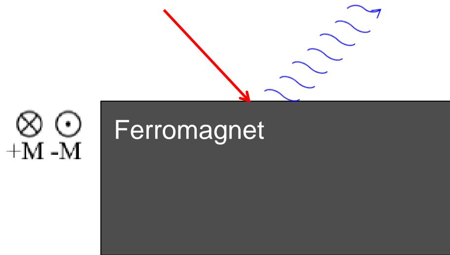
$$P_i(2\omega) = \chi_{ijk}^{(2)}(-2\omega; \omega, \omega) : E_j(\omega)E_k(\omega)$$
